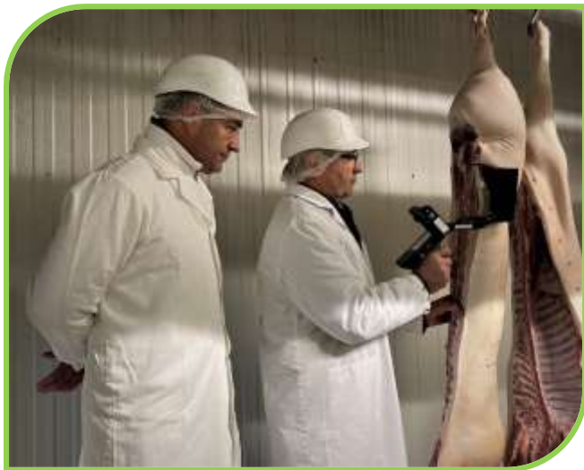
Technischer Fortschritt auf oberösterreichischen Schlachtbetrieben durch das Schweineklassifizierungsgerät OptiScan TPC
